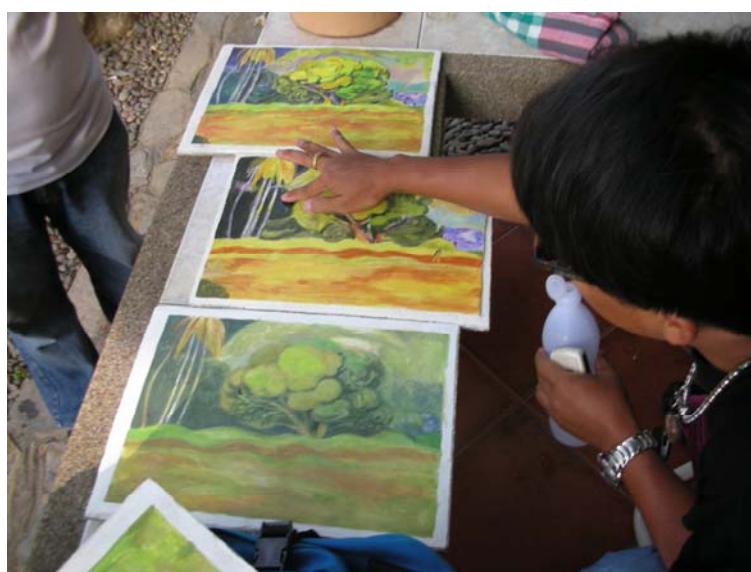
ภาพแสดงการทดสอบด้วยการใช้น้ำทลายผลงานหลังการเขียนเสร็จ 8 ชั่วโมง
