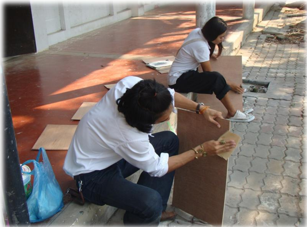
ขัดตกแต่งขอบและพื้นกระดานอัดให้เรียบร้อยด้วยกระดาษทรายหยาบ จากนั้นจึงเลือกใช้วิธีการ ดังนี้
