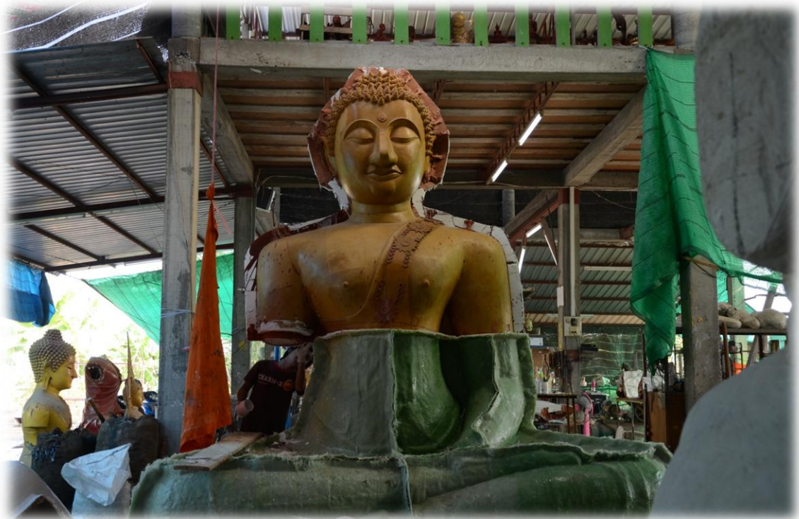
ขึ้นรูปด้วยขี้ผึ้งขึ้น ทำพิมพ์ด้วยเรซินครอบต้นแบบเลย
