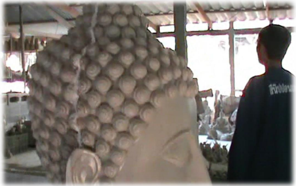
ขั้นตอนการกั้นพิมพ์ ตัดแผ่นอลูมิเนียมลงไปเพื่อทำการแบ่งพิมพ์เป็นสองซีก
